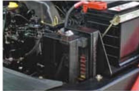
Le nouveau filtre à air comprenant une admission tangentielle et un joint double avec filtre de sécurité est gage de longévité. Il est plus résistant à la corrosion et aux vibrations que le précédent.
